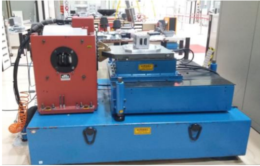
Fig. 5 – NanoMirax EM Vibration Test
